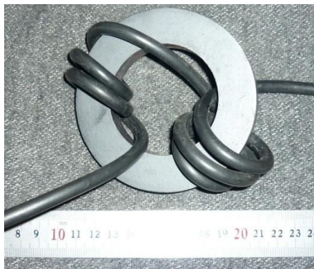
3+3 витка противофазно
