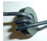
Два витка (снаружи) – 5 мкГн
