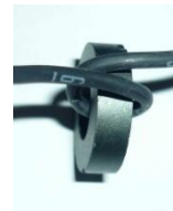
Один виток (снаружи) - 0,7 мкГн
